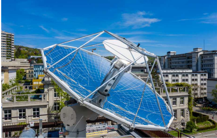
Die Forschungsanlage, mit der sich synthetische flüssige Treibstoffe herstellen lassen, die bei der Verbrennung nur so viel CO 2 freisetzen, wie zuvor der Luft entnommen wurde, steht auf dem Dach des ETH-Gebäudes. (Bild: ETH Zürich / Alessandro Della Bella)
